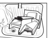
Reinigen Sie den Weichspülkanal mit warmem Wasser und einer Bürste.
